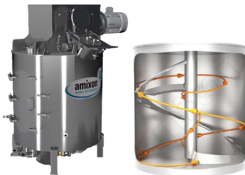
Рисунок 1.6 - Змішувач вертикальний одновальний стрічковий і схема циркуляції продукту
