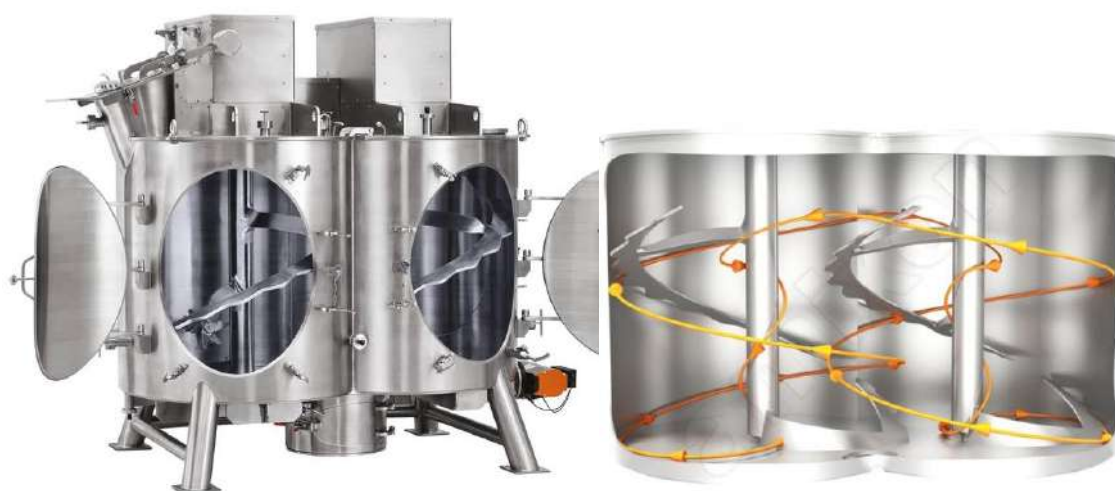
Рисунок 1.7 - Змішувач вертикальний двовальний стрічковий і схема циркуляції продукту
