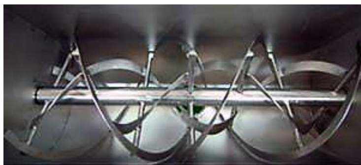
Рисунок 1.5 - Вал із двома стрічками конструкції типу «S»
