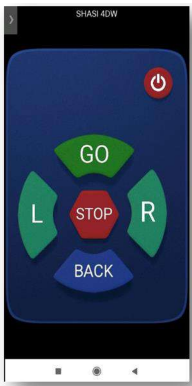
Рисунок 4.7 – Загальний вигляд пульта управління; команди: «GO» – рух вперед; «BACK» – рух назад; «L», «R» – поворот ліворуч і праворуч відповідно; «STOP» – повна зупинка моторів
