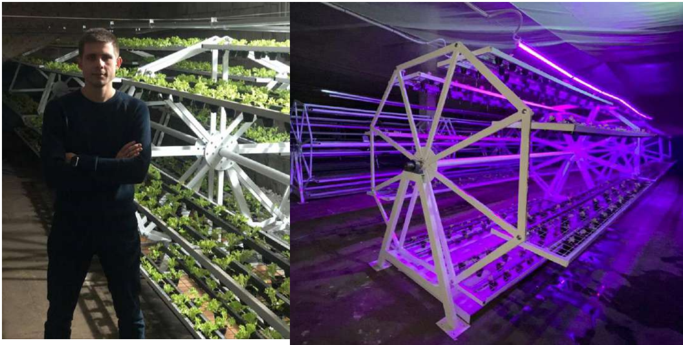
Рисунок 4.8 – Експериментальні дослідження процесу вирощування листя салату з використанням багаторярусної гідропонної установки
