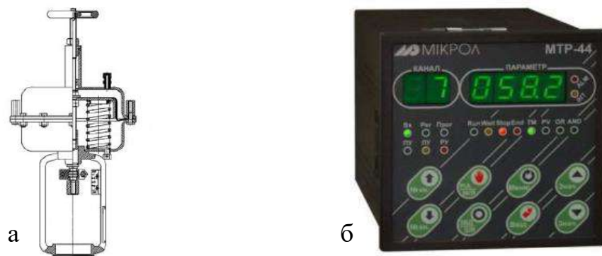
Рисунок 1.30 – Схема мембранного виконавчого механізму з верхнім ручним підстійним елементом (а); б – загальний вигляд мікропроцесорного регулятора МТП-44
