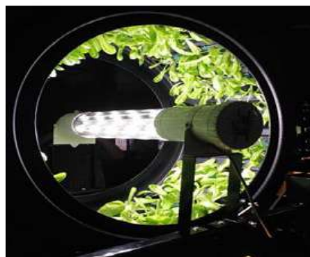
Рисунок 1.8 – Конструкція поворотної гідропонної системи
