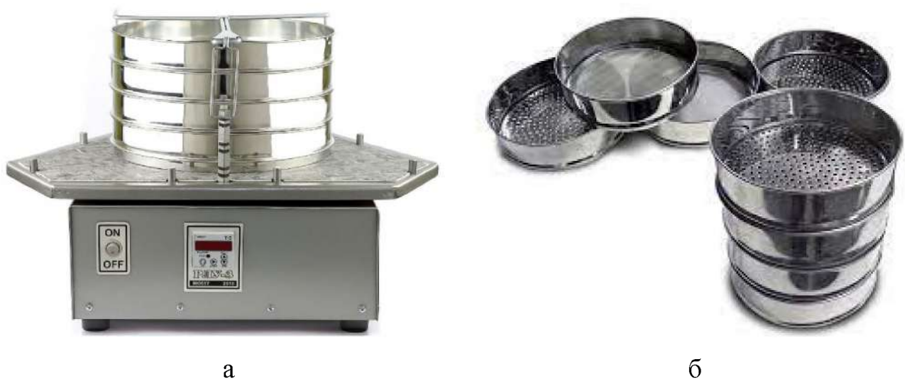
Рисунок 3.1 – Загальний вигляд лабораторного розсіву РЛУ-3 (а) і набору сит із отворами круглої форми СЛ-200 (б).
