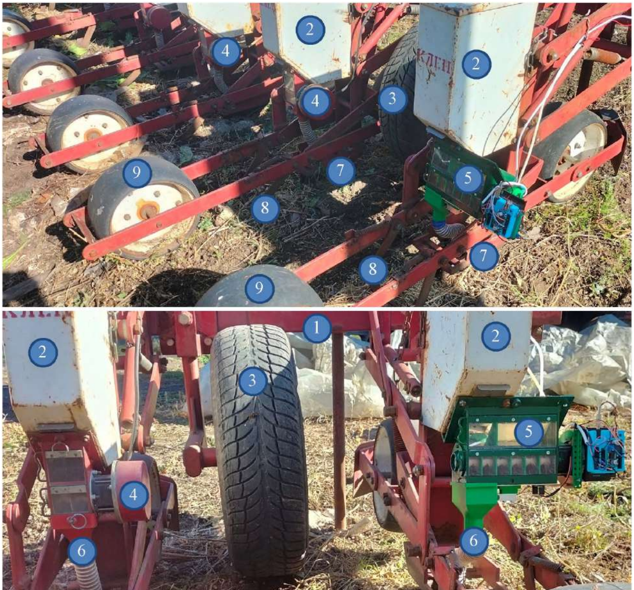
Рисунок 5.5 – Загальний вигляд висівної секції із удосконаленим висівним апаратом:
