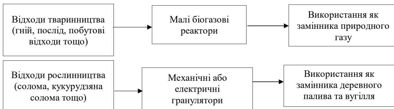
Рисунок 1.5 – Принципова схема переробки відходів сільськогосподарської діяльності в особистих селянських господарствах на біогаз та тверде біопаливо
