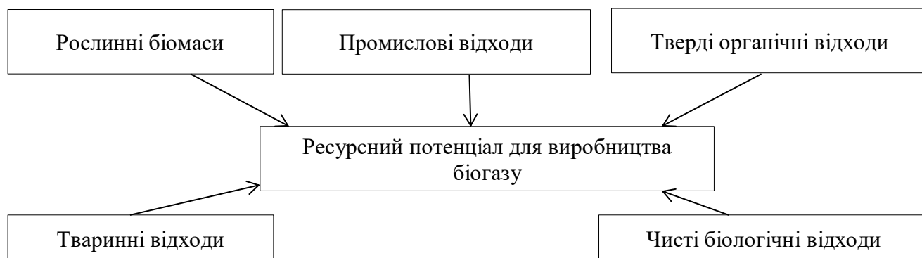
Рисунок 2.1. – Складові ресурсного потенціалу для виробництва біогазу
