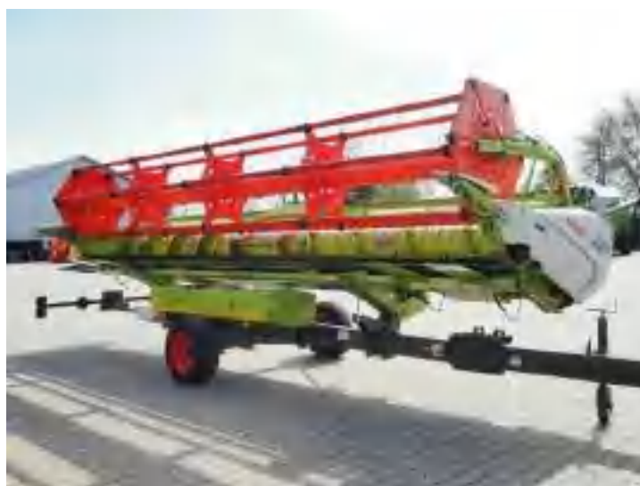
Рис. 2. зернозбиральна жатка Claas Vario 630.
