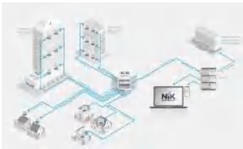
Рис. 3. Системи автоматизованого обліку електроенергії АСКОЕ – NIK.
