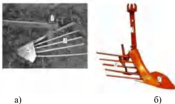
Рис. 1. Копачі-просівального типу: а – з лемешем клиноподібної форми; б – з леміж плугоподібної форми; 1 – сошка; 2 – леміш; 3 – просівальні прутки.
