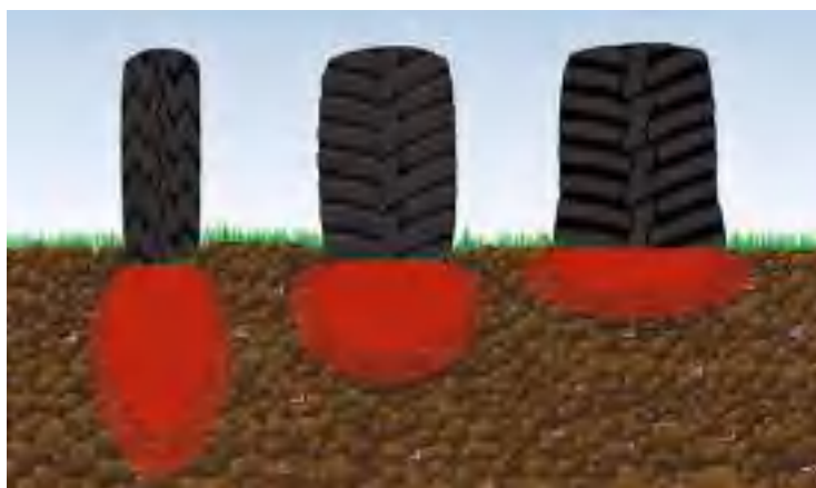
Рис. 3. Ущільнення ґрунту під різним діаметром шин.
