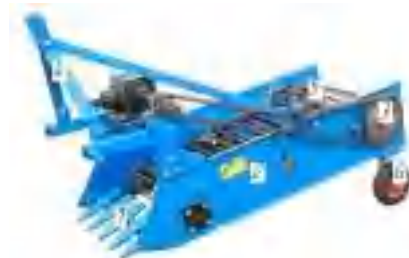
Рис. 5. Картоплекопач елеваторного типу: 1 – підкопуючий робочий орган; 2 – рама; 3 – привод пруткового елеватора; 4– пристрій навішування на трактор; 5 – прутковий елеватор; 6 – ходові колеса.
