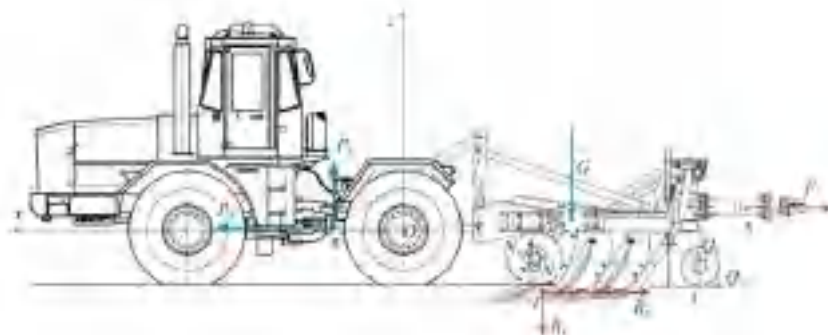
Рис. 5. Схема для розрахунку сил, що діють на глибокорозпушувач з трактором.
