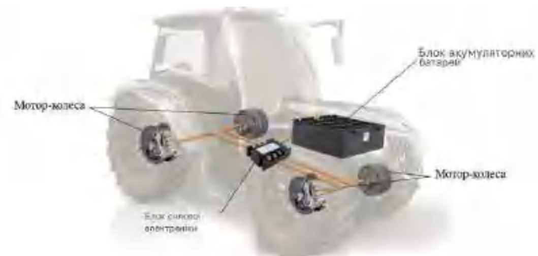
Рис. 6. Схема електромобіля з акумуляторним живленням і електричною трансмісією.
