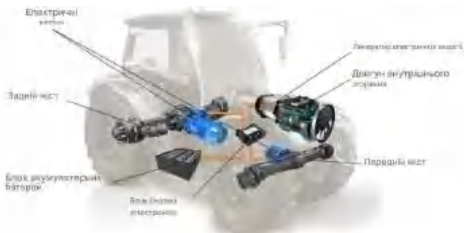
Рис. 3. Схема гібридного силового автомобіля з електромеханічною трансмісією.
