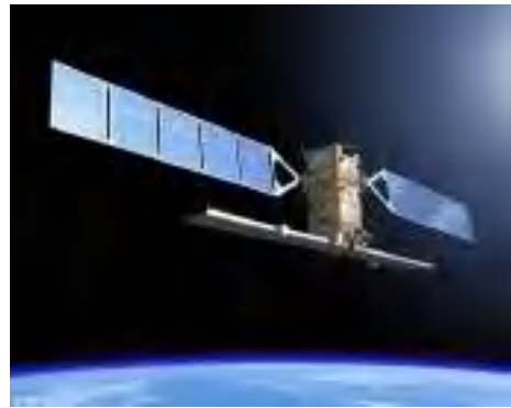
Рис. 5. Супутник з мікрохвильовим радаром «Sentinel-1»
