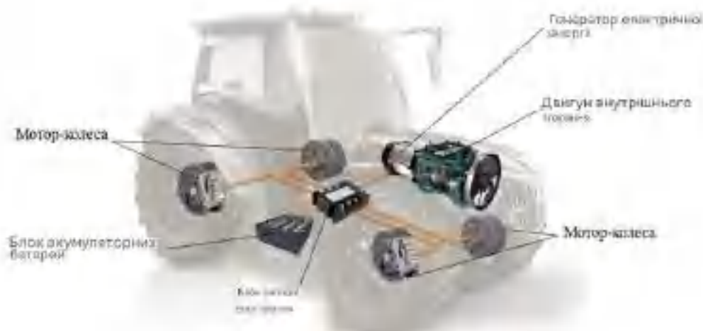
Рис. 4. Схема гібридного силового автомобіля з електричною трансмісією.
