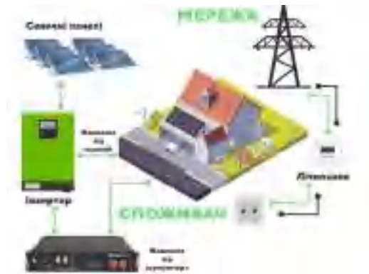
Рис. 2. Схема гібридної сонячної електростанції на даху будинку [9].
