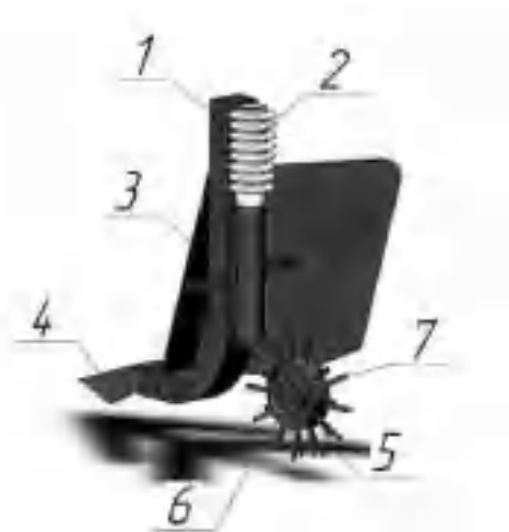
Рис. 1. Схема сошника для підґрунтового-розкидного внесення твердих мінеральних добрив.
