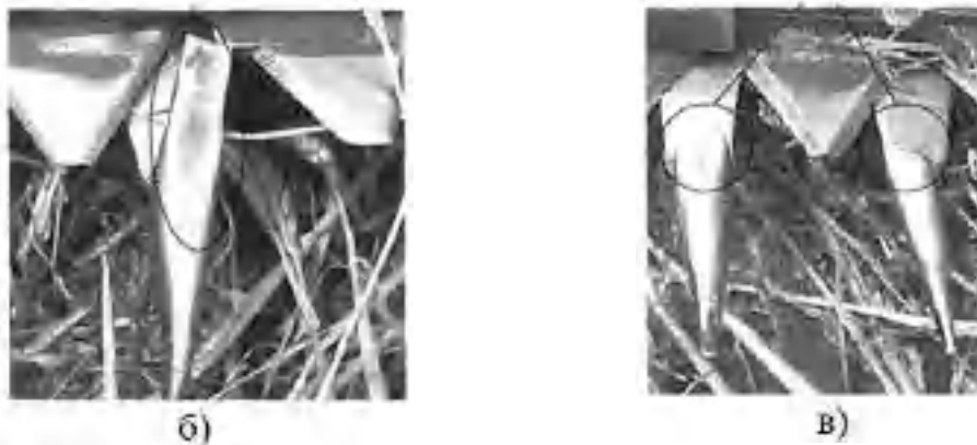
Рис. 2. Наслідки раптової відмови: а) пошкодження сегмента; б-в) пошкодження елементів пальцевого бруса.
