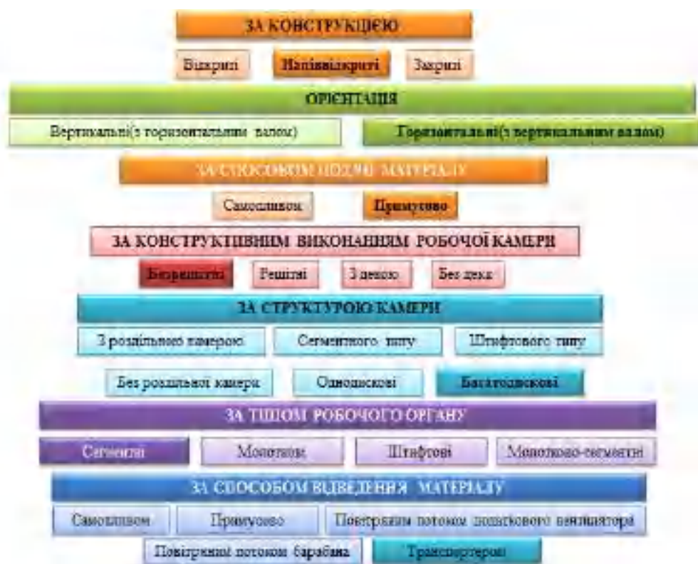
Рис. 1. Блок-схема, класифікація подрібнювачів довгостеблових кормів.
