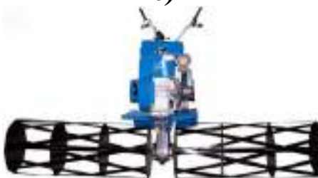
а – зубова борона; б - дискова борона, в - голчаста борона, г - роторна борона Рис. 2. Борони для малогабаритної техніки
