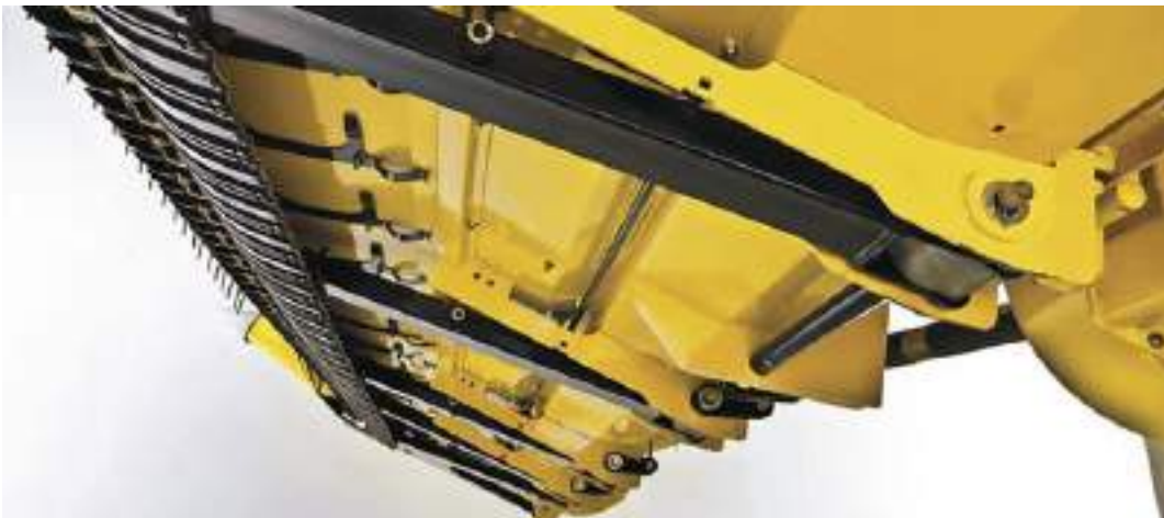
Рис. 8. Система гідравлічного регулювання прогину різального апарата.
