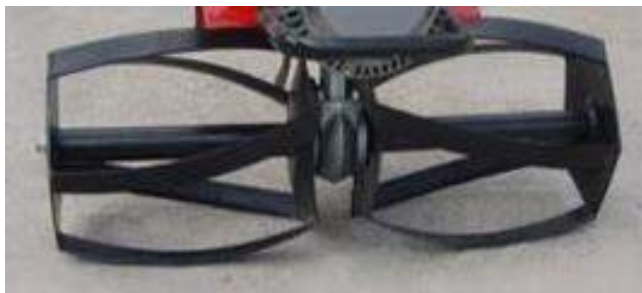
Рис. 7 Фреза «Активний ротор» із спіралеподібними ножами
