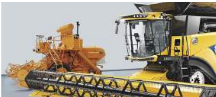
Рис. 5. Комбайн New Holland з двороторною системою обмолоту та сепарації Twin Rotor.
