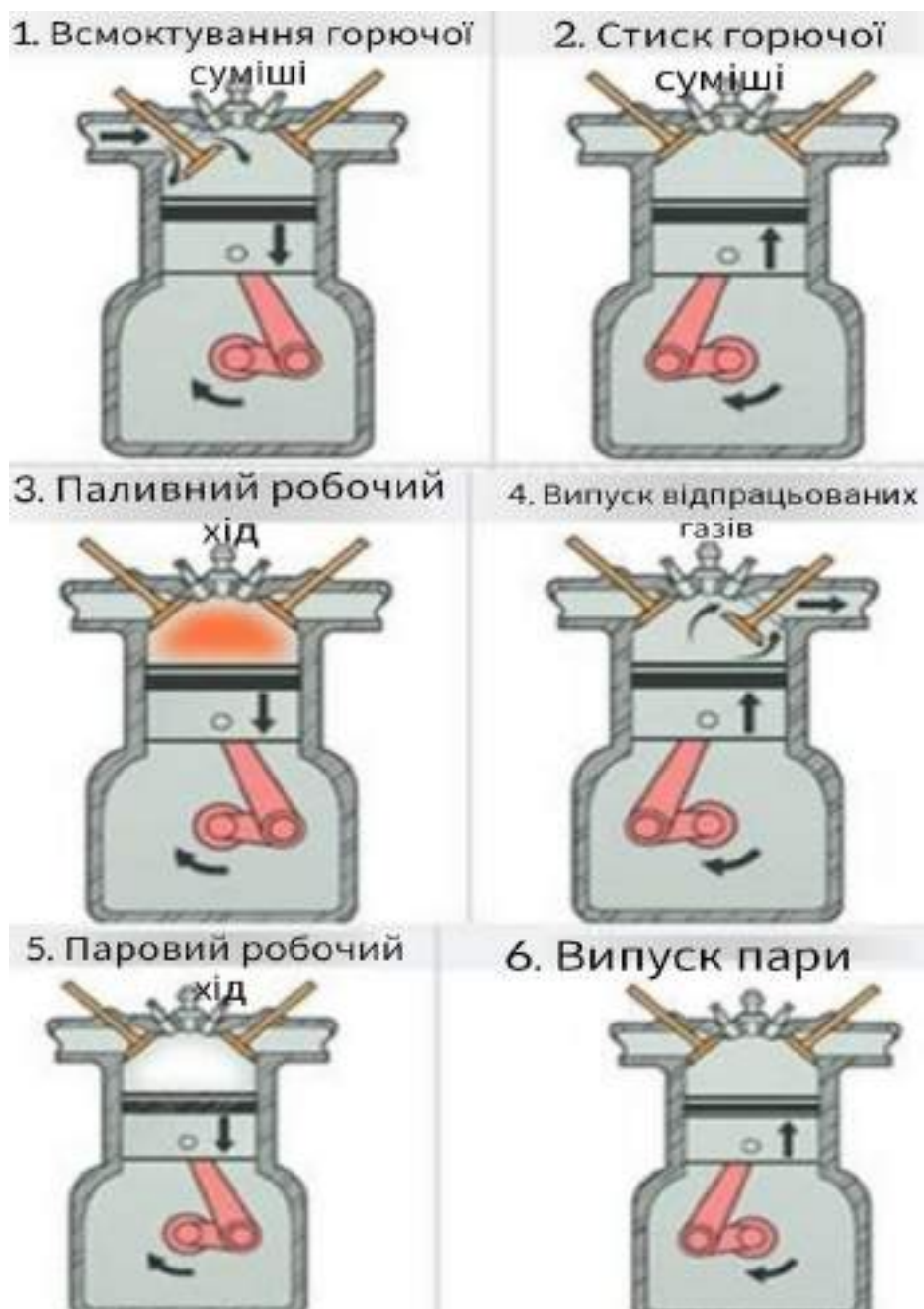
Рис. 1. Шеститактний цикл ДВЗ
