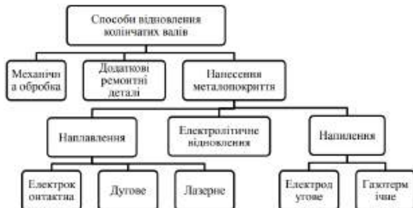
Рис. 1. Класифікація способів ремонту і відновлення колінчастих валів
