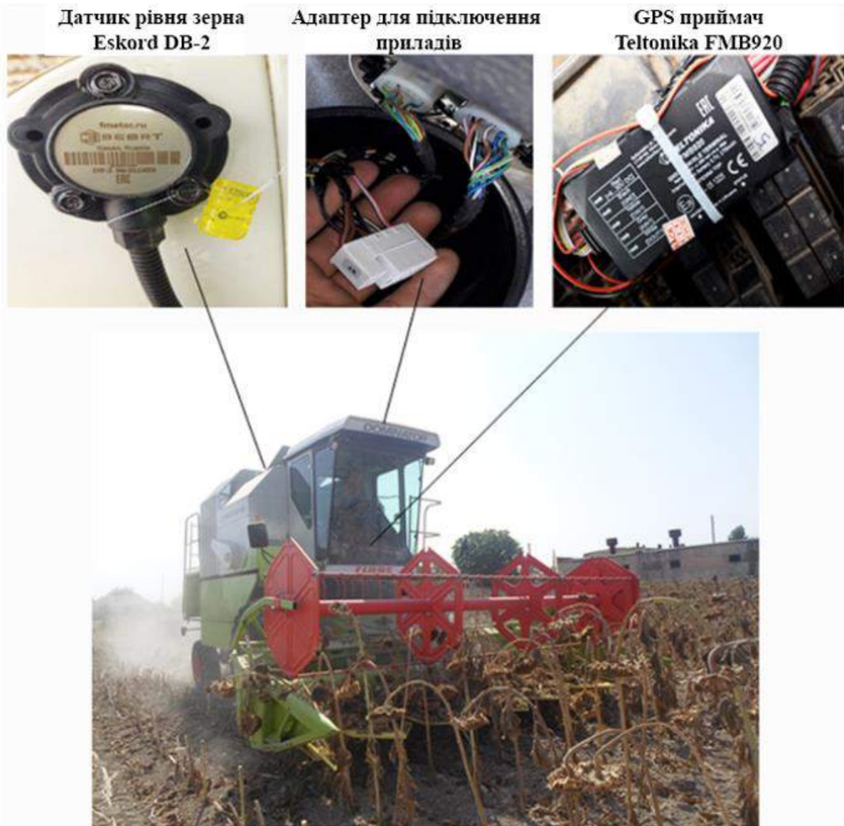
Рис. 2. Зовнішній вигляд адаптованого зернозбирального комбайна, обладнаного GPS-приймачем та датчиком зерна.
