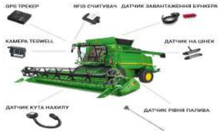
Рис. 1. Основні компоненти систем автоматичного управління
