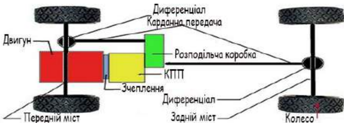
Рис. 1. Схема трансмісії повнопривідної техніки
