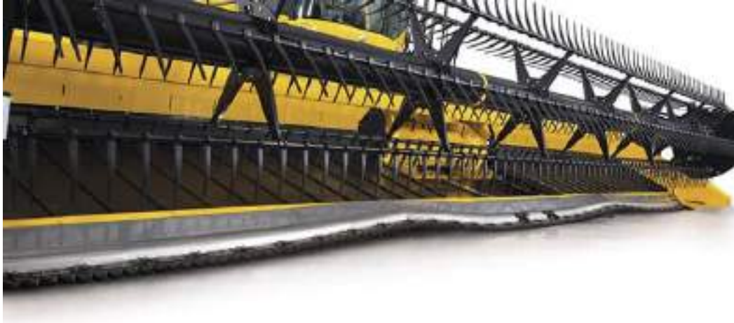
Рис. 7. Система регулювання прогину різального апарата з гумовими пружинами.
