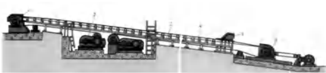
Рис. 3. Схема функціонування похилого стрічкового конвейєра: 1 – розвантажувальний пристрій; 2 – привод; 4 – стрічка; 5 – завантажувальний пристрій.
