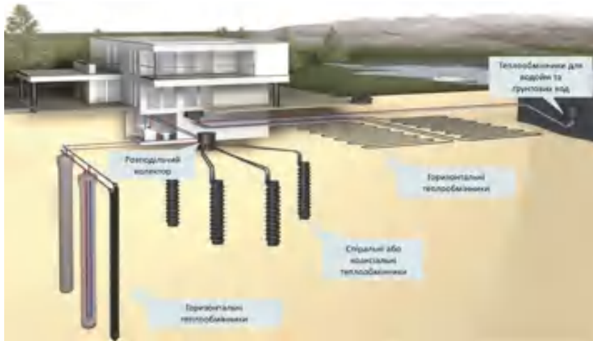
Рис. 1. Ґрунтові теплообмінники для геотермальних систем з різними типами колекторів.
