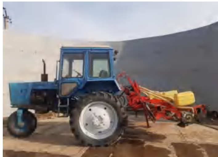
Рис. 2. Пневматична сівалка з точним висівом голого насіння бавовнику - експериментальний екземпляр, агрегований з трактором.
