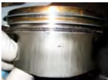
Рис. 2. Знос елементів ЦПГ
