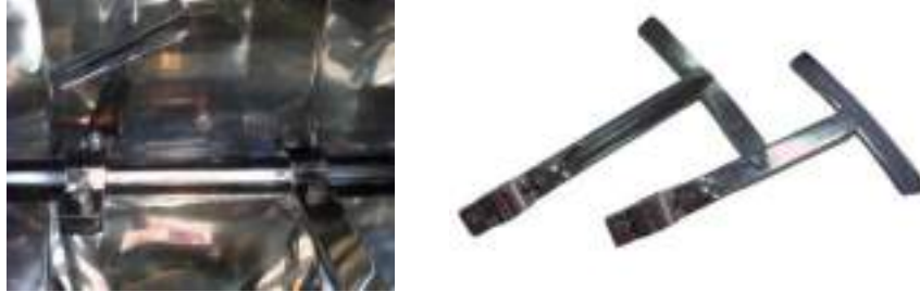
Рис. 4. Вал та робочі органи конусного змішувача
