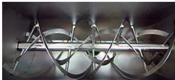
Рис. 6. Вал з двома стрічками конструкції типу "S"
