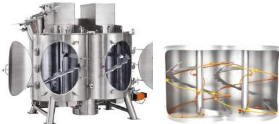
Рис. 8. Вертикальний двохвальний стрічковий змішувач та схема циркуляції продукту
