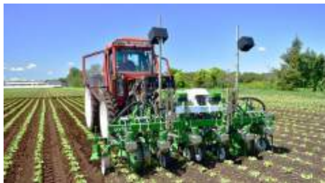
Рис 5. Рух агрегату при міжрядному обробітку
