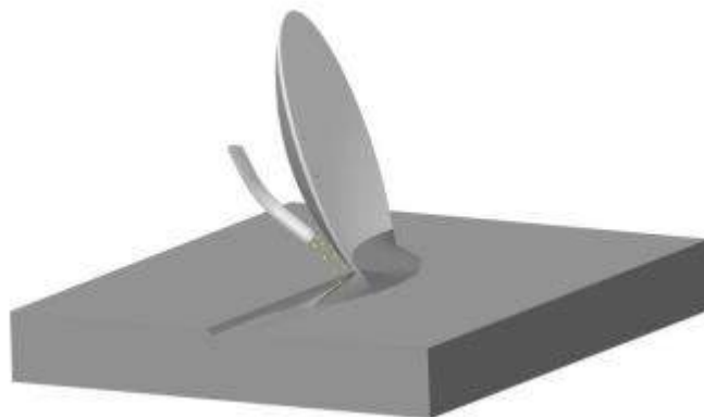
Рис. 2. Технологічна схема роботи сферодискового сошника
