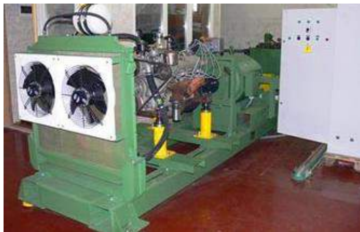
Рис 2. Стенд для обкатки і випробовування двигунів ГОСНИТИ КИ-35503.
