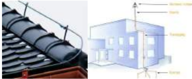
Рис. 1 Установка грозвідвідника на житловій споруді
