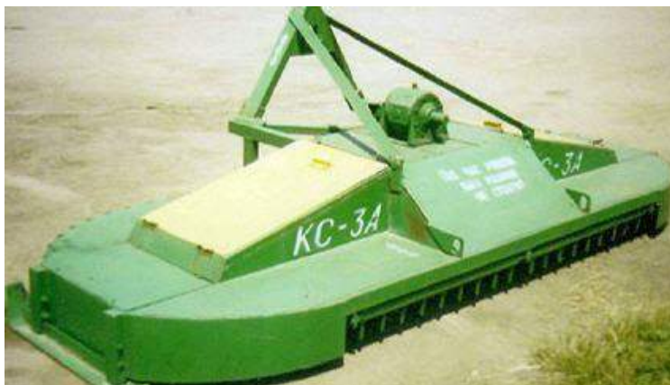
Рис 1. Дисковий подрібнюючий апарат з горизонтальним розміщенням подрібнюючих роторів КС-3А.
