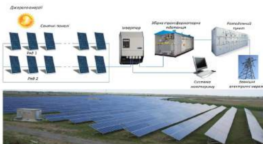
Рис 3. Технологічна схема СЕС
