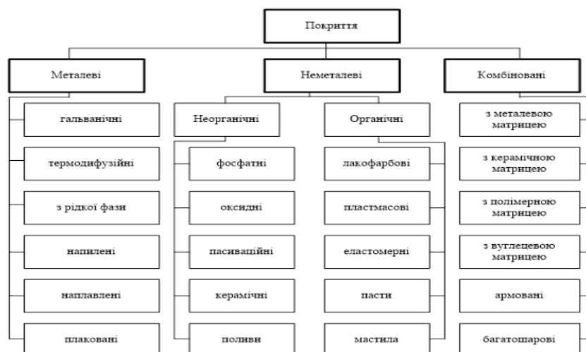
Рис. 4. Класифікація протикорозійних покриттів
