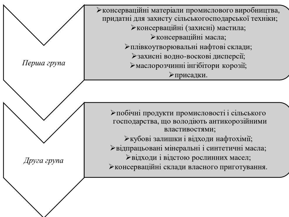
Рис 1. Групи тимчасового захисту сільськогосподарських машин від корозії
