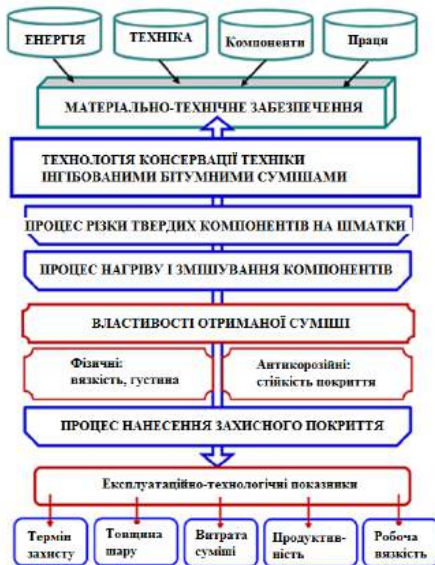
Рис 6. Схема розробки технології консервації техніки інгібованими бітумними складами.
