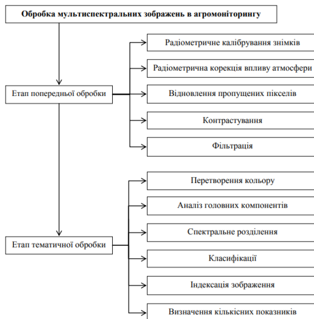
Рис. 1. Схема обробки мультиспектральних зображень в агромоніторингу
