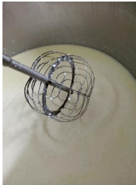
Рис. 3. Саморобна ліра із нержавіючої сталі
