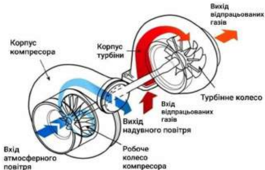
Рис. 1 Система турбонадування, принцип роботи
