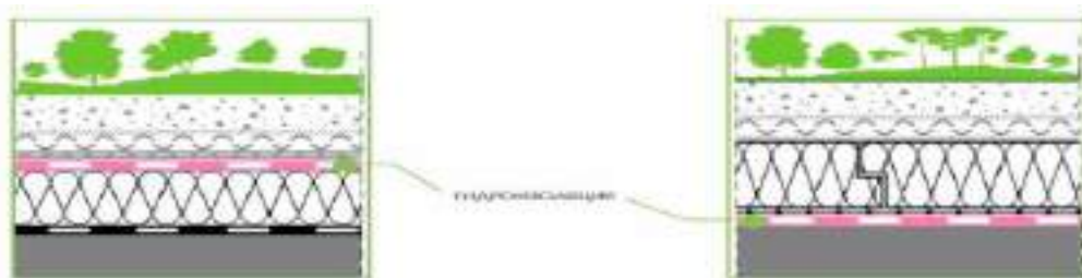
Рис.4 Різновиди дахів за технологією (тепла, інверсійна)
