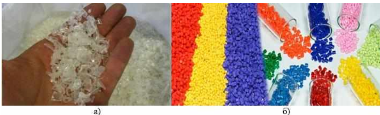
Рис. 2. Продукти переробки полімерів: а) флекс; б) гранулянт.
