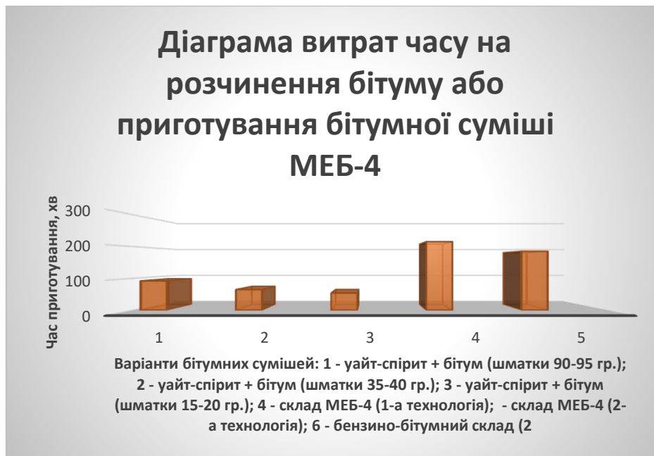
Рис. 5. Діаграма витрат часу на розчинення бітуму або приготування бітумної суміші МЕБ-4.
