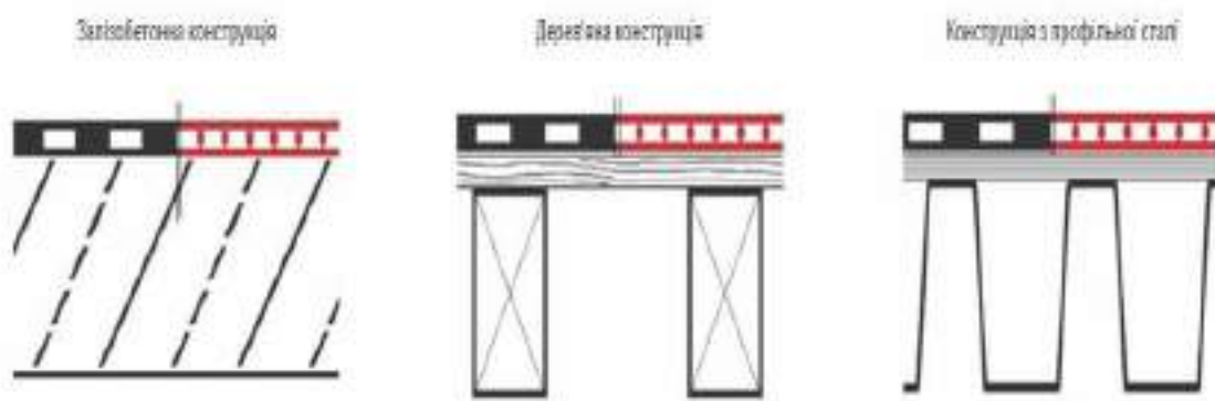
Рис.5 Різновидність дахів за несучою конструкцією
