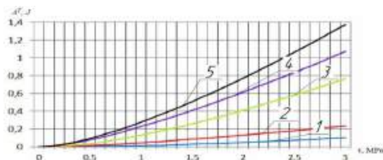
Рис. 1. Залежність теоретичної роботи руйнування зерна кукурудзи від нормальних напружень при значеннях вологості [2]: 1. W=13-14%; 2. W=16-17%; 3. W=19-20%; 4. W=22-23%; 5. W=25-26%.
