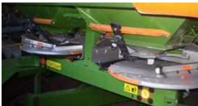
Рис. 4. Робочі органи для внесення мінеральних добрив
