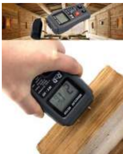
Рисунок 2 – Вологоміри, побудовані на кондуктометричному методі
