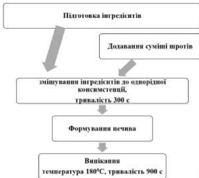
Рис. 1. Технологічна схема виробництва пісочного печива за додавання шроту олійних культур
