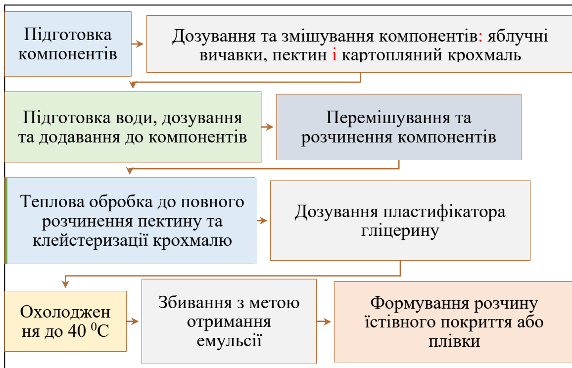
Рис. 3. Технологічна схема отримання формувального розчину їстівного покриття/плівки
