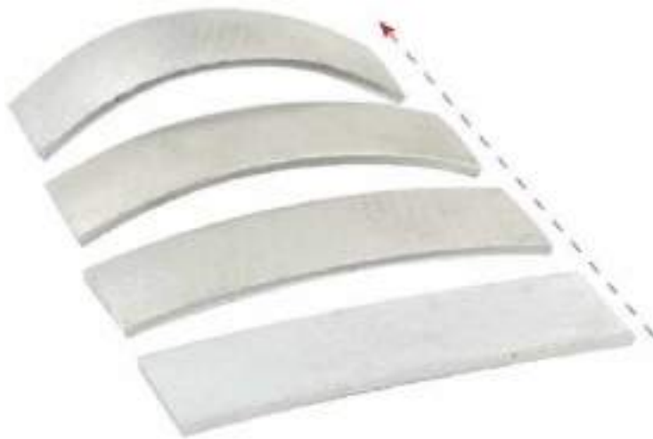
Рисунок 5. Утворення дуги після дробоструминної обробки
