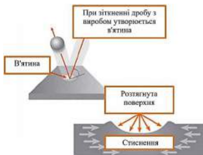
Рисунок 1. Процес утворення вм'ятин на поверхнях при дробоструминній обробці
