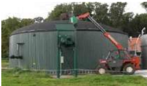
Рисунок 2. Завантаження твердого наповнювача в біореактор
