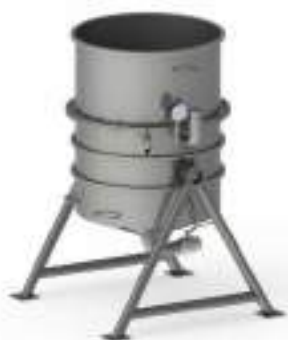
Рис. 1. Відкритий нутч-фільтр 1 – корпус; 2 – фільтрувальна перегородка.
