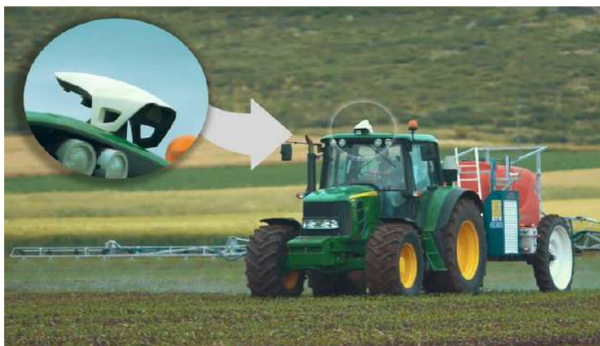
Рис. 5. Встановлення польового аналізатора від Augmenta
