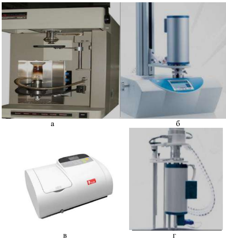
Рис. 7. Термічний аналіз: а) термогравіметрія; б) диференціально-термічний аналіз; в) диференціально-скануючу калориметрію; г) термо-механічний аналіз
