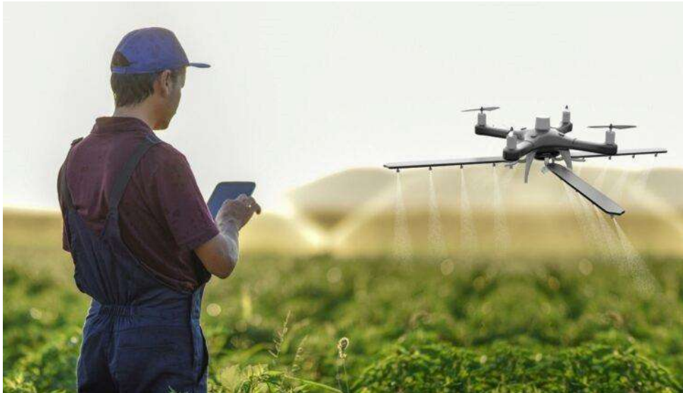
Рис. 1. Оператор здійснює керування дроном-обприскувачем
