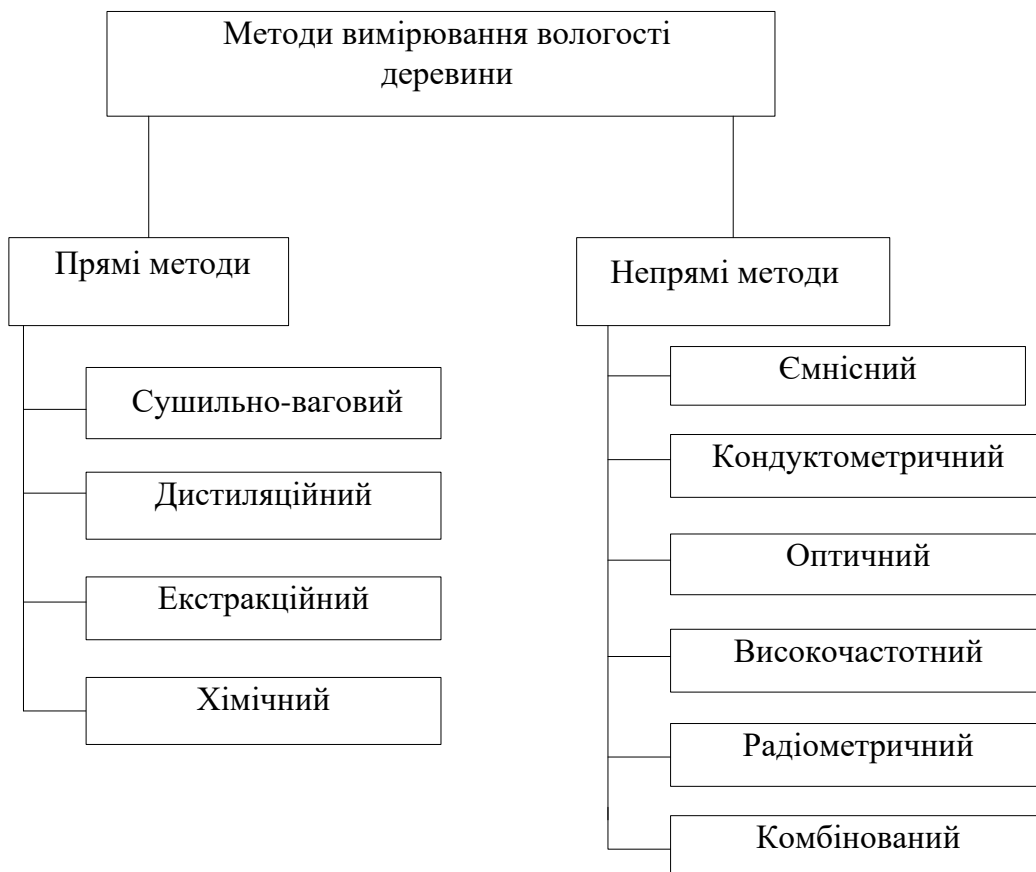
Рис. 1. Методи вимірювання вологості деревини
