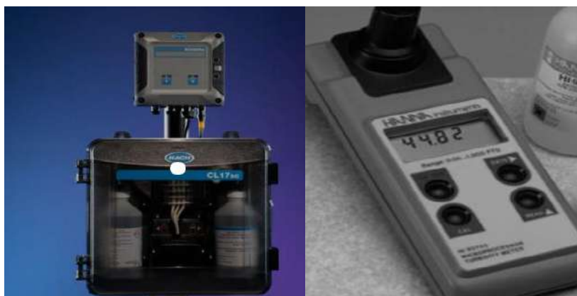
Рис.4. Пристрої: а) фотометричний аналізатор; б) нефелометричний метод
