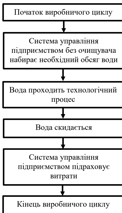
Рис. 1. Блок схема розрахунку витрат для сільськогосподарських підприємств, що не використовують оборотне водопостачання
