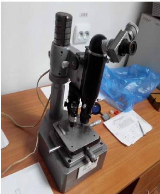
Рисунок 3.2 – Прилади для вимірювання мікротвердості поверхні ПМТ-3 та МФН-11
