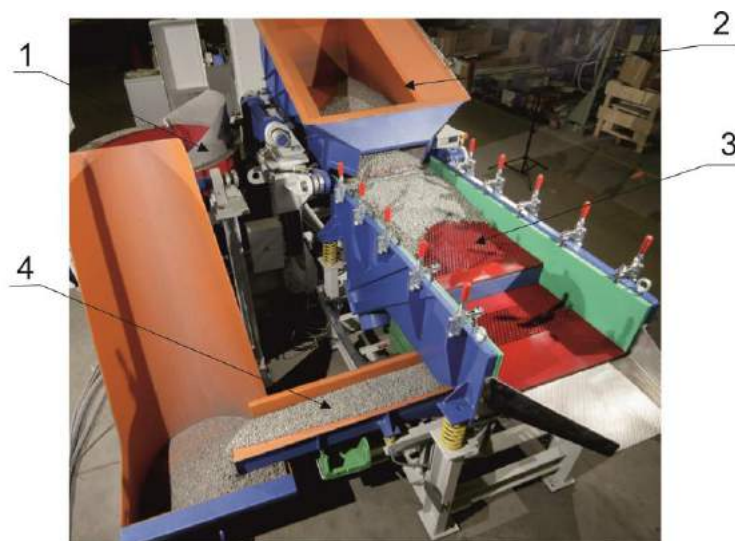
Рисунок 1.9 – Комплекс фірми «Walther Trowal» для віброабразивної обробки деталей: 1 – тороїдальна вібраційна технологічна машина; 2 – вібраційний бункерний живильник; 3 – вібросепаратори; 4 – віброток
