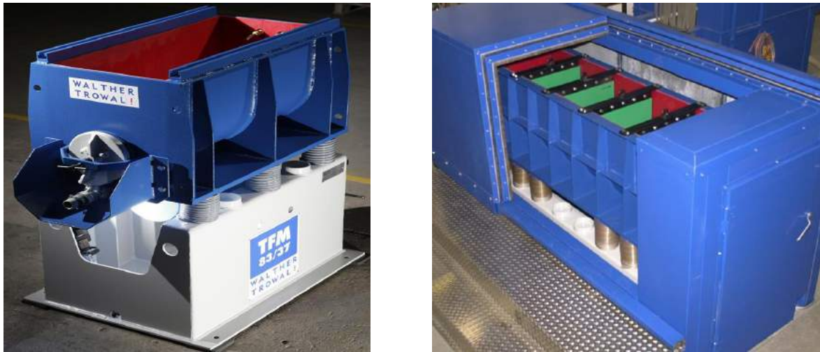
Рисунок 1.11 – Багатокамерні універсальні неавтоматизовані ВТМ загального призначення фірми «Walther Trowal»
