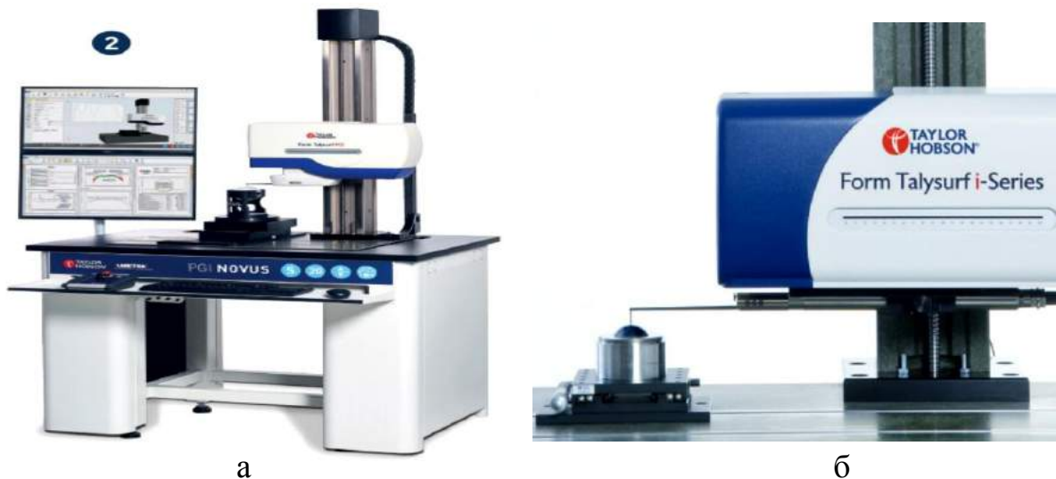
Рисунок 3.3 – Обладнання для дослідження шорсткості поверхні: а – профілограф-профілометр «Talyscan 450»; б – скануюча головка «Talysurf i-Series»
