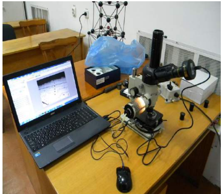
Рисунок 3.2 – Прилади для вимірювання мікротвердості поверхні ПМТ-3 та МФН-11
