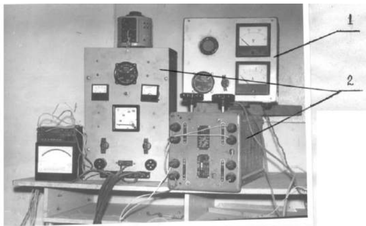
Рисунок 2.Г.1 – Пульт оцінки та керування параметрами електричного струму при експериментальних дослідженнях: 1 – прилади для оцінки параметрів електричного струму; 2 – прилади для регулювання частоти обертання приводного вала активатора вібромашини
