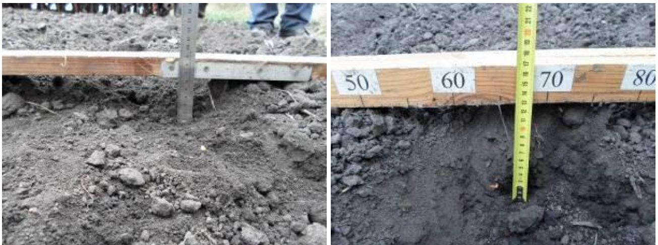
Рис. 3.6 – Експериментальне визначення глибини розміщення у ґрунті:
