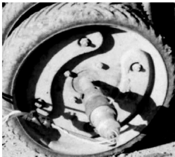
Рис. 3.3 – Шляховимірювальне колесо для контролю швидкості руху комбінованого удобрювально-посівного агрегату
