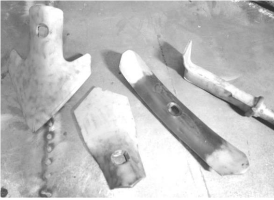
Рис. 6. Загальний вигляд робочих органів після віброзміцнювальної обробки
