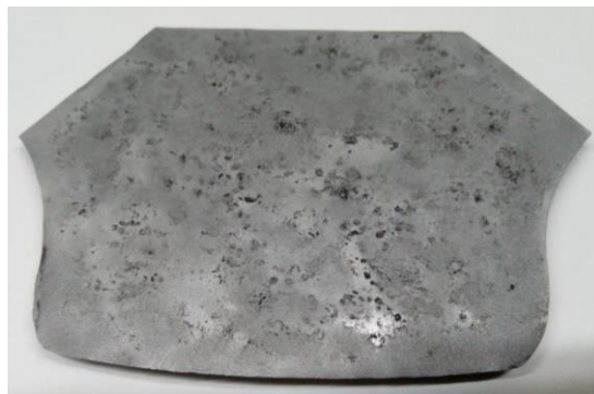
Рис. 5. Загальний вигляд робочих органів після віброзміцнювальної обробки параметрами оптимізації, які характеризують показники процесу віброзміцнювальної обробки робочих поверхонь ґрунтообробних знарядь були: енергетичні витрати N , кВт·год.; висота мікронерівності R , мкм; твердість поверхні T , HV.
