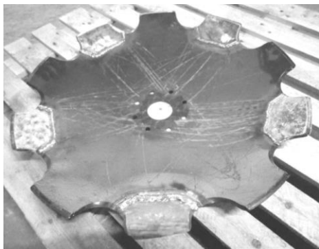
Рис. 5. Загальний вигляд робочих органів після віброзміцнювальної обробки параметрами оптимізації, які характеризують показники процесу віброзміцнювальної обробки робочих поверхонь ґрунтообробних знарядь були: енергетичні витрати N , кВт·год.; висота мікронерівності R , мкм; твердість поверхні T , HV.
