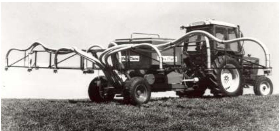
Рис. 1.6. Загальний вигляд машини для внесення мінеральних добрив “Usta-Matic”, яка обладнана двома багатоканальними пневматичними ТРО транспортуючого типу
