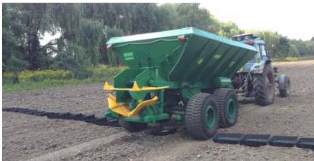
Рис. 3.7. Загальний вигляд машини МРД-8, яка обладнана двома ТРОН, під час проведення лабораторно-польових досліджень
