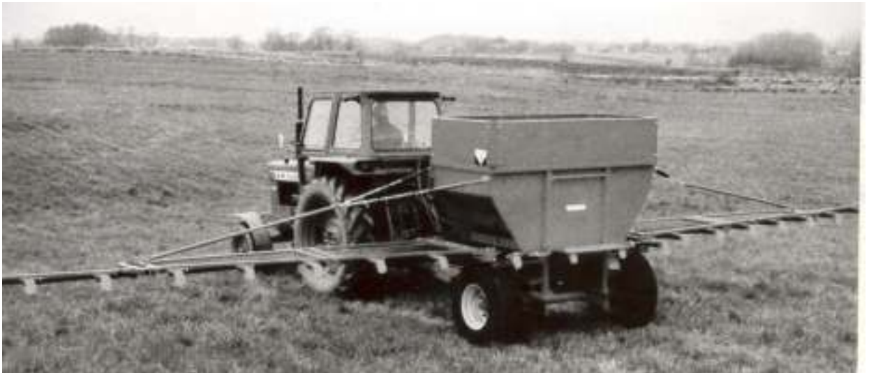
Рис. 1.5. Загальний вигляд машини для внесення мінеральних добрив “Tive”, яка обладнана двома багатоканальними пневматичними ТРО транспортуючого типу
