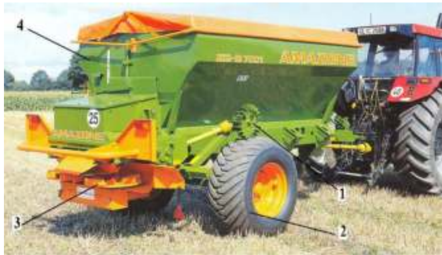
Рис. 1.3. Загальний вигляд машини для внесення мінеральних добрив ZG-B 7001 фірми “Amazonen-Werke”(ФРН), обладнаної двома ТРО:
