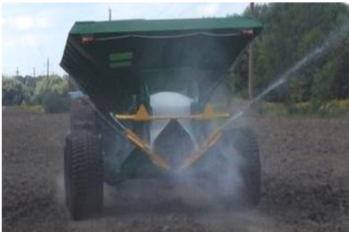
Рис. 5.1. Загальний вигляд машини МРД-8, обладнаної двома ТРОН, під час виробничої перевірки
