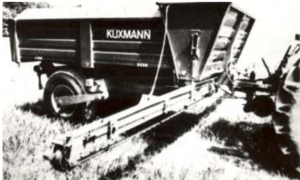
Рис. 1.9. Загальний вид машини для внесення добрив “Kuxmann 413”, яка обладнана двома стрічковими ТРО транспортуючого типу
