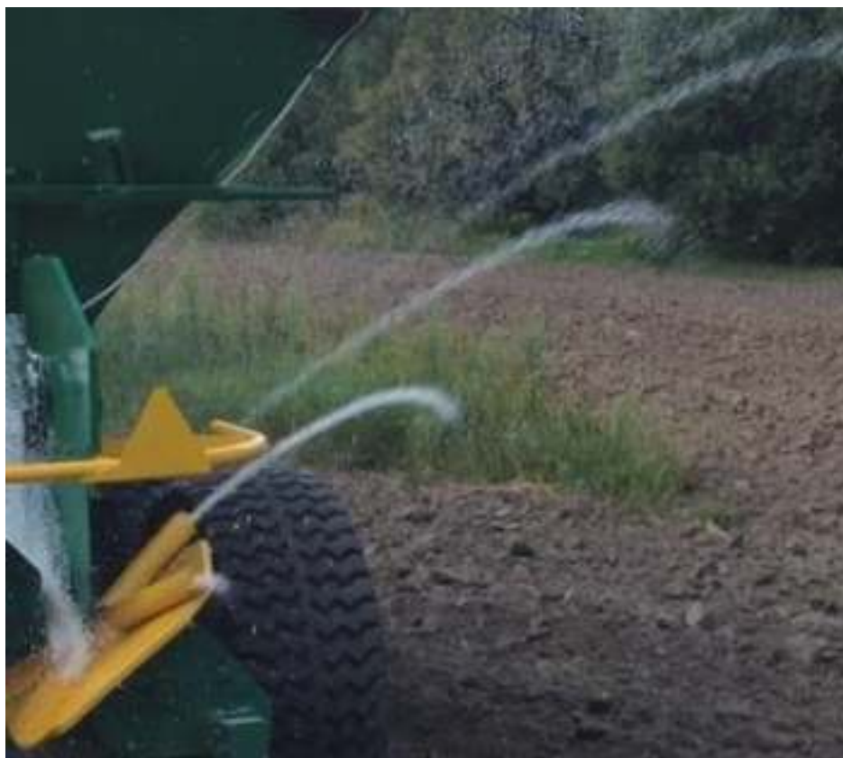
Рис. 5.2. Загальний вигляд дослідного зразка ТРОН під час виробничої перевірки (для наочності частота обертання диска ТРОН становила 350 об/хв)
