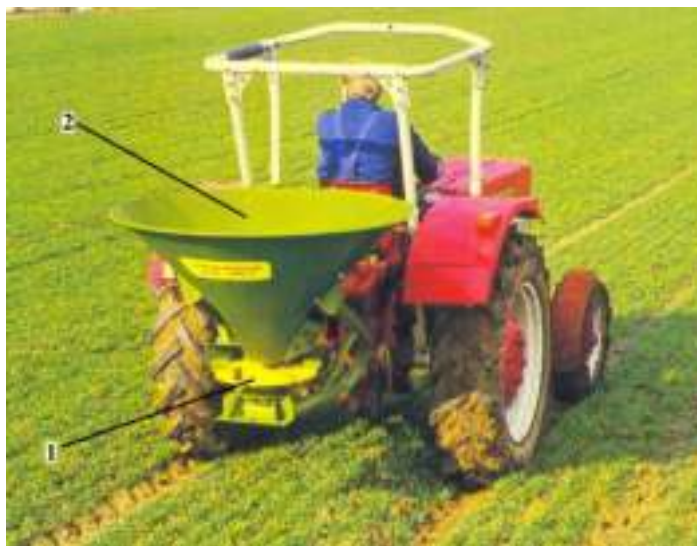
Рис. 1.2. Загальний вигляд машини для внесення мінеральних добрив ЕК-301 фірми “Amazonen-Werke” (ФРН), обладнаної тукорозсівним робочим органом (ТРО): 1 – ТРО; 2 - технологічна місткість
