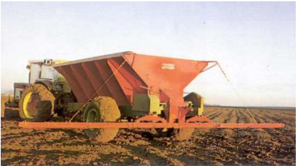
Рис. 1.10. Загальний вигляд машини для внесення мінеральних добрив, обладнаної ТРО шнекового типу DE-325 фірми “Nodet Gougis” (Франція)
