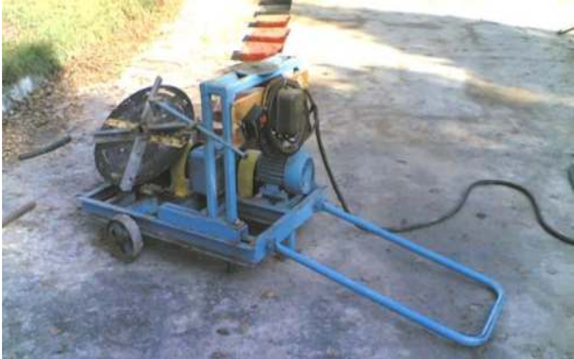
Рис. 3.5. Загальний вигляд експериментальної установки з деками, встановленими для дослідження розподілу мінеральних добрив у напрямку їх розсівання (для наочності поворотна рама і бункер зняті)
