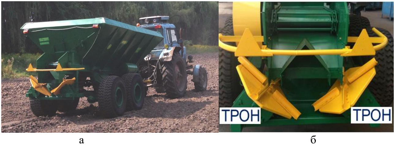
Рис. 8. Загальний вигляд: а, б - відповідно машини для внесення мінеральних добрив, обладнаної двома ТРОН, та 2-х ТРОН
