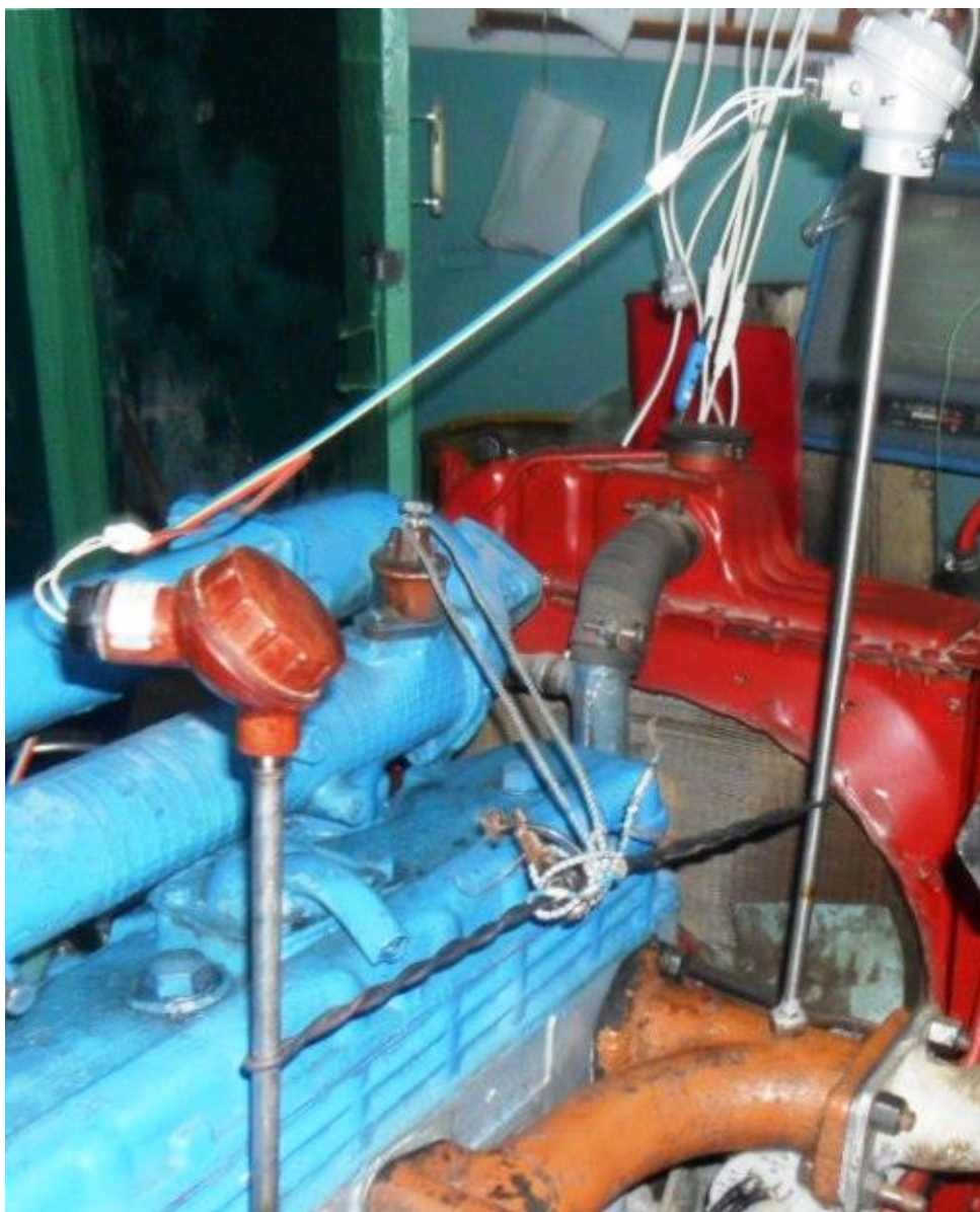
Рисунок 3.11 – Монтування термопар для визначення температури газів у випускному колекторі напроти першого та четвертого циліндрів
