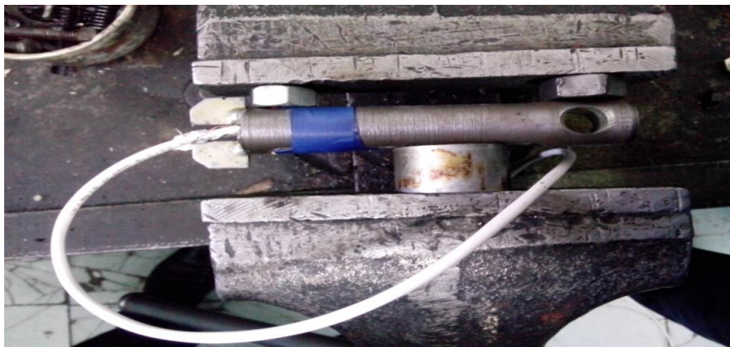
Рисунок 3.20 – Визначення працездатності тензомостів у лабораторних умовах
