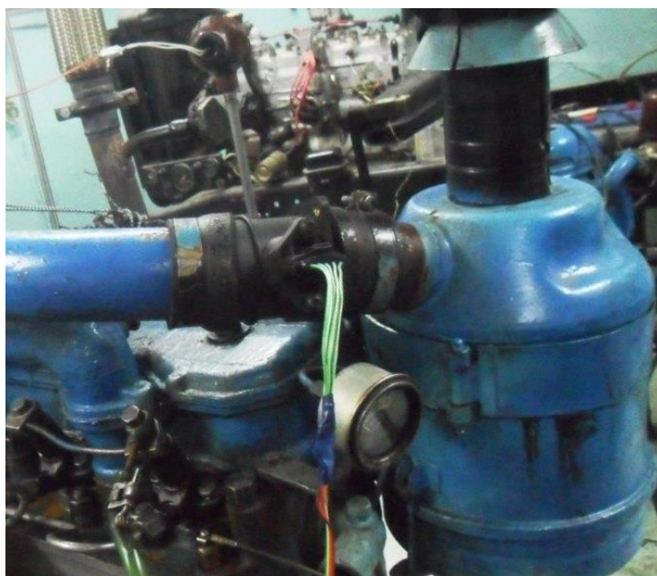
Рисунок 3.9 – Монтування між повітроочисником та впускним колектором витратоміра повітря BOSCH 0280218116
