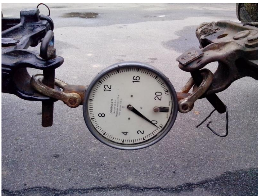
Рис. 3.21 – Перевірка працездатності та проведення тарування тензомостів
