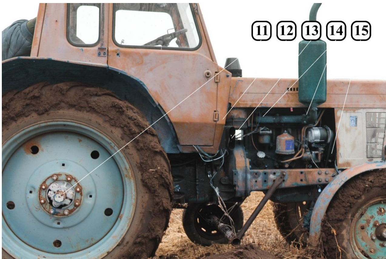
Рисунок 3.15 – Монтування вимірювального обладнання на експериментальній установці на базі трактора МТЗ-80 в агрегаті з плугом ПЛН-3-35 а) вигляд зліва; б) вигляд справа
