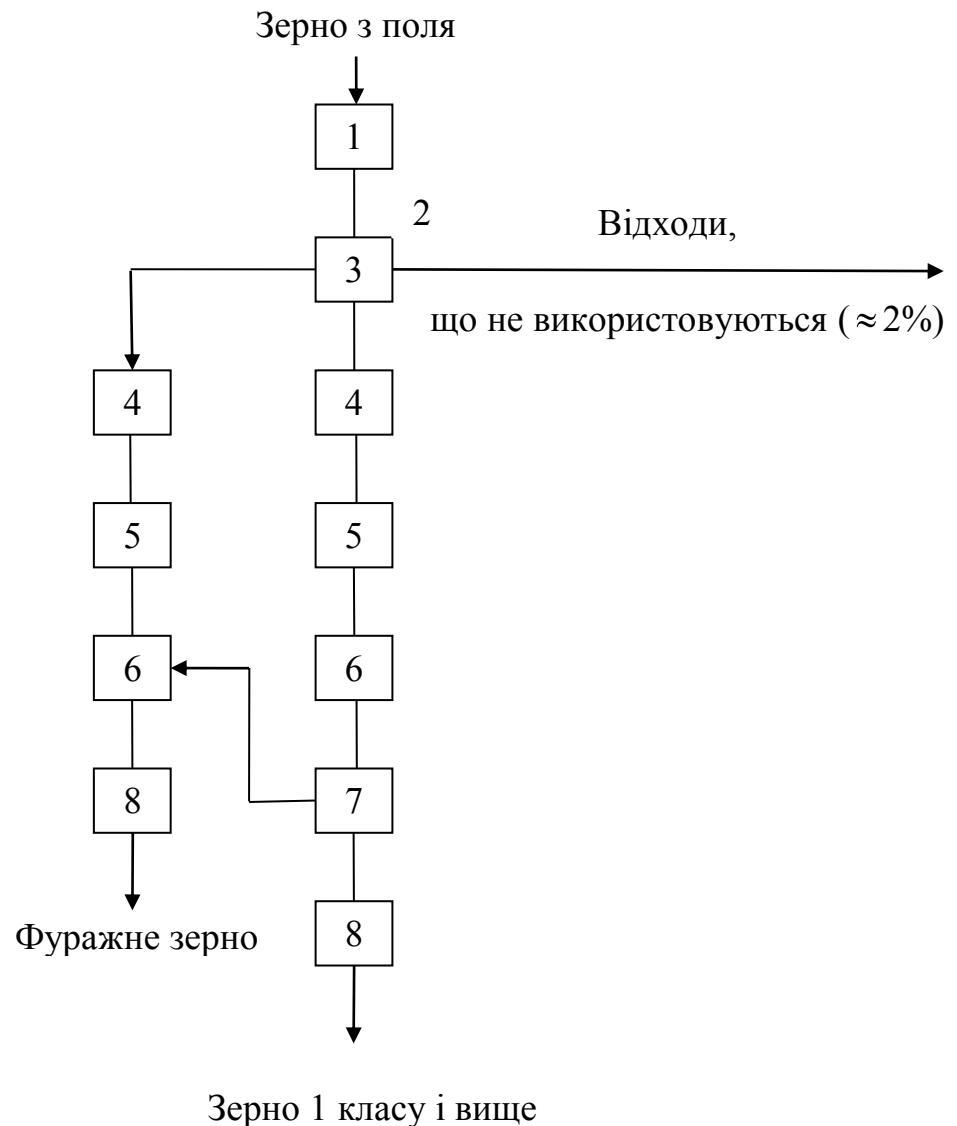
1 – живильник; 2 – транспортування зернової сировини; 3 – машина попереднього очищення; 4 – бункер активного вентиляювання; 5 – віброозонуючий комплекс; 6 – бункер для відлежування; 7 – машина первинного та вторинного очищення; 8 – розвантажувальний конвеєр Рисунок 5.1 – Схема лінії післязбиральної обробки зернової сировини
