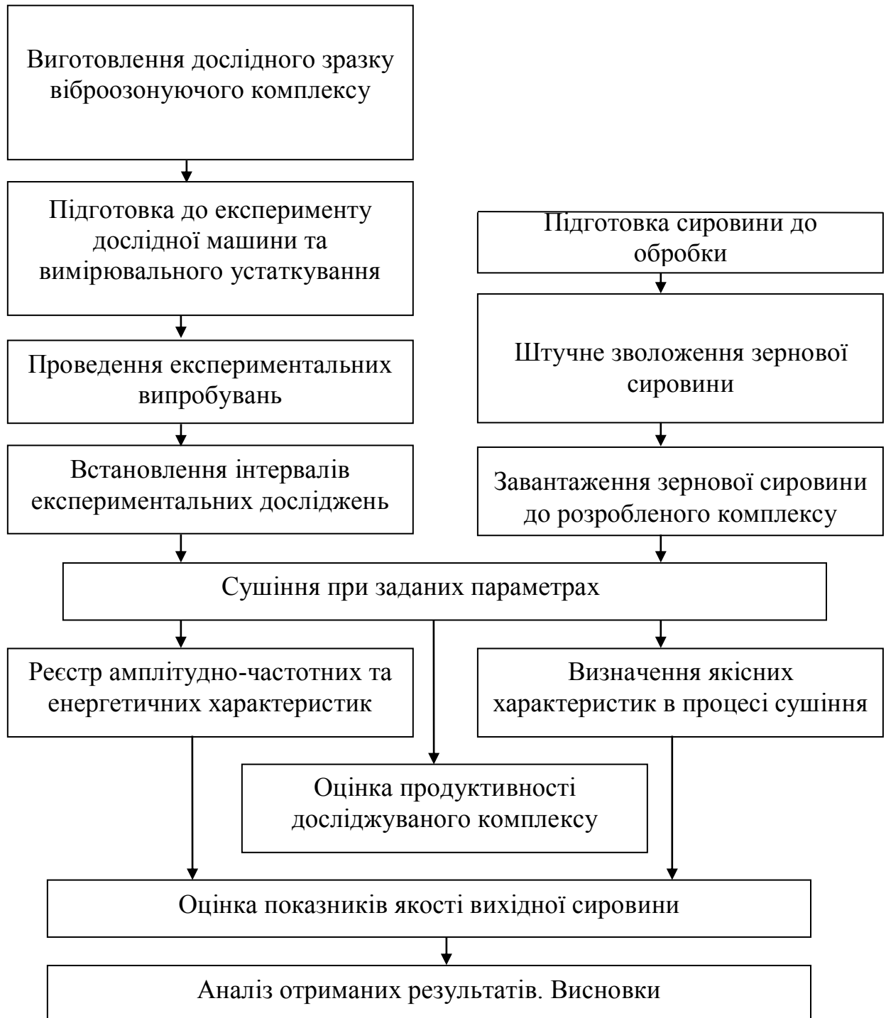
Рисунок 3.2 – Блок-схема підготовки та проведення експериментальних досліджень розробленого віброозонуючого комплексу
