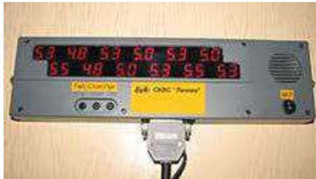
Рис.5. Система контролю висіву насіння «Impulse-1»
