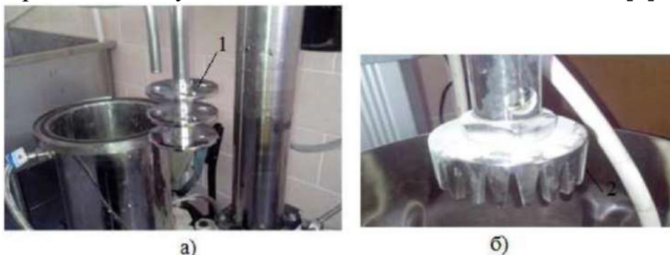
Рис. 4. Загальний вигляд розмельних елементів у вигляді: а - помольних дисків 1; б - гребінок 2 [6]
