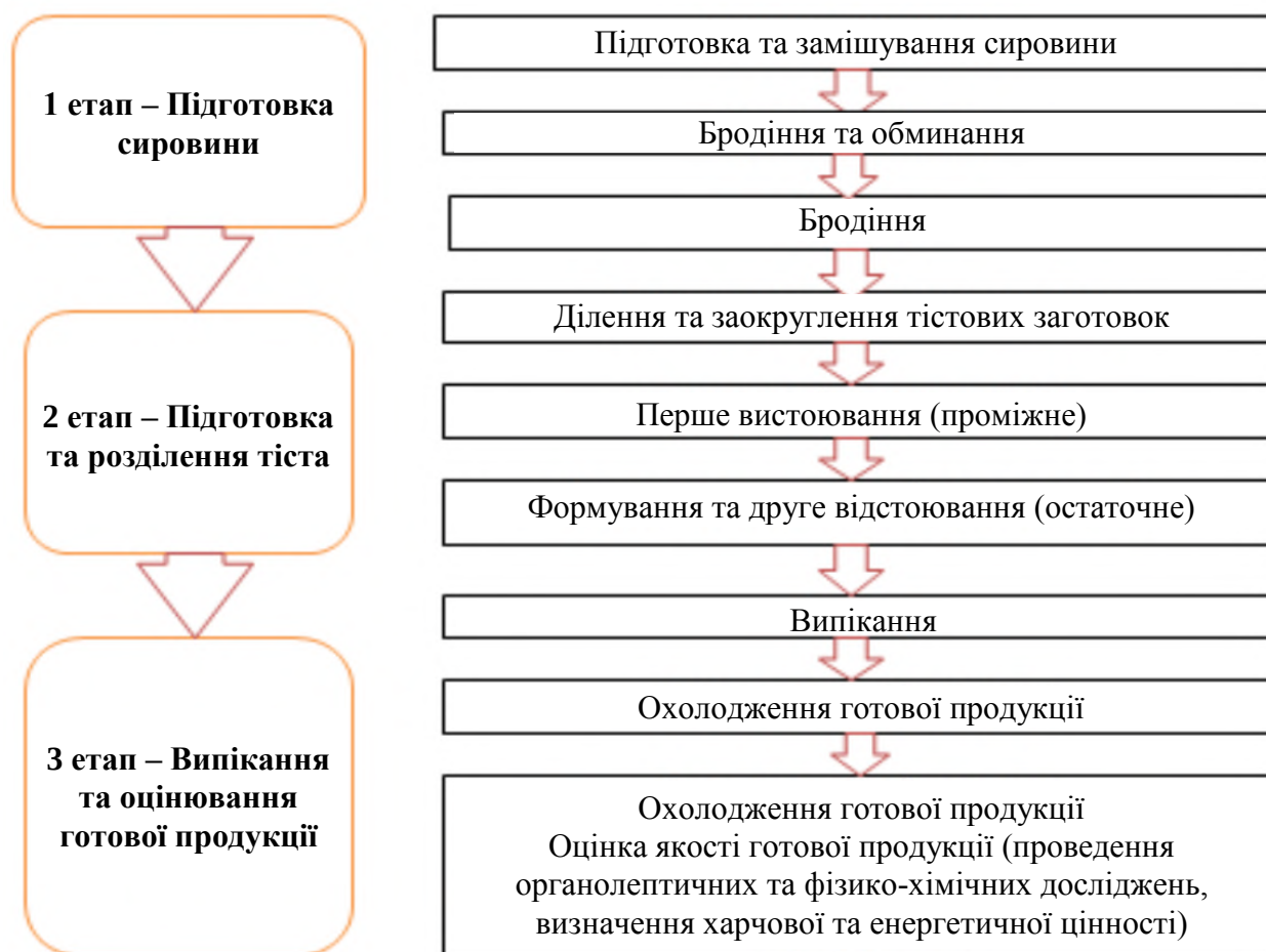
Рис. 4 – Принципова схема виробництва хліба з композитною сумішшю безопарним способом
