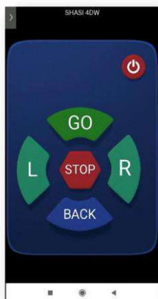
Рис. 8 – Інтерфейс пільта ДУ: «GO» – рух вперед; «BACK» – рух назад; «L», «R» – поворот ліворуч і праворуч відповідно; «STOP» – повна зупинка моторів
