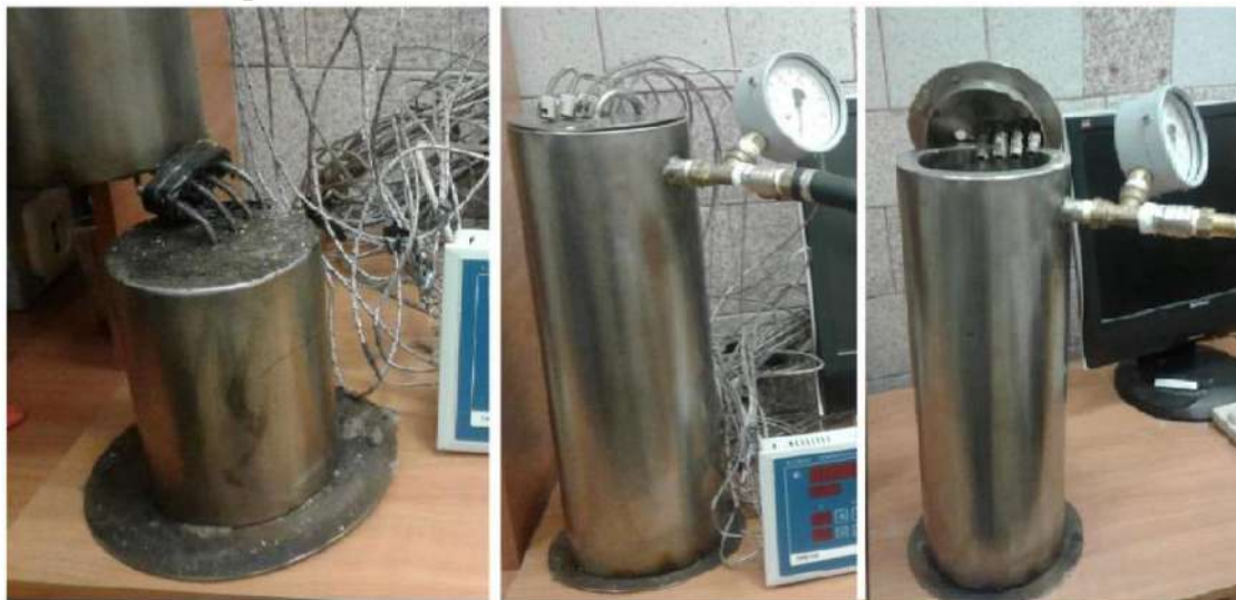
Рис. 1 – Зовнішній вигляд окремих елементів установки конвективного нагріву та охолодження в розібраному вигляді: а – нижня частина теплової труби охолодження вугілля, підключена до термопар; б – складена тепла труба без теплоізоляції зі вставленою бюксою нагрівання технологічної щепи; в – тепла труба в розібраному вигляді [5]
