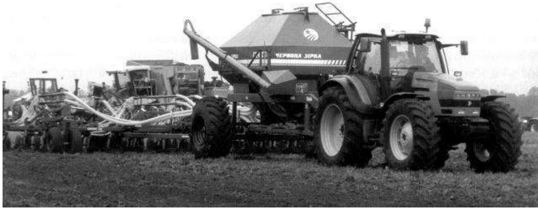
Рис. 1 Комбінований ґрунтообробно-посівний агрегат на базі сівалки прямого висіву виробництва ВАТ «Червона зірка»
