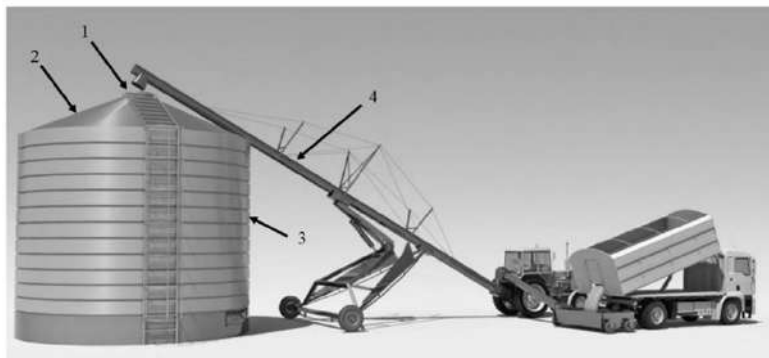
Рис.2 - Завантаження силосу з конусоподібним дахом: 1 - на пластину; 2 - дах; 3 - стінка ємності; 4 - завантажувальний пристрій.
