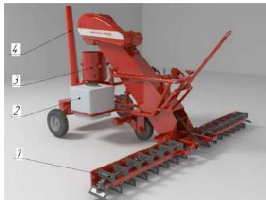
Рис. 7 – Самопересувний протравлювач насіння KLEVER: 1 – скребковий живильний пристрій; 2 – резервуар для хімікатів; 3 – камера протруювання; 4 – вивантажувальний шнек
