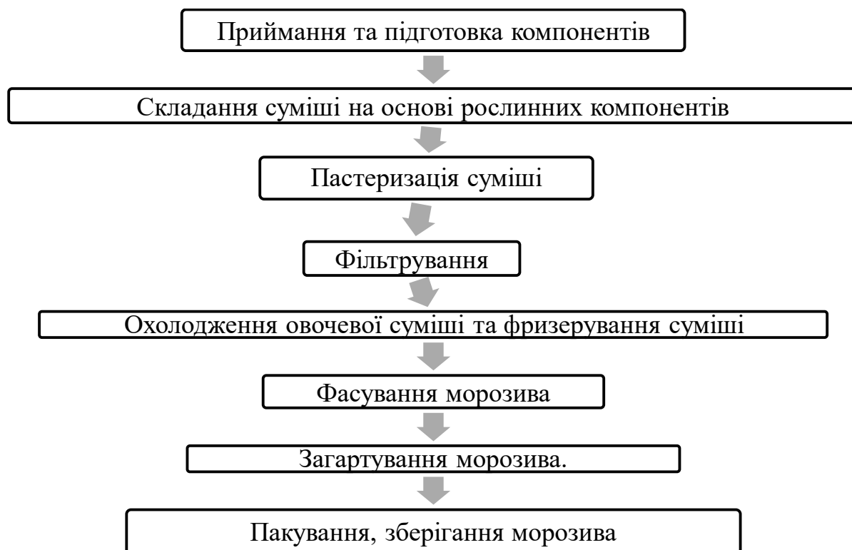
Рис. 1. Технологічна схема виробництва морозива для веганів
