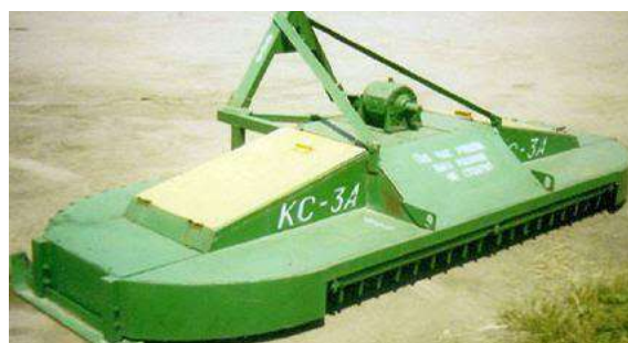
Рис. 1 – Дисковий подрібнюючий апарат з горизонтальним розміщенням подрібнюючих роторів КС-3А.
