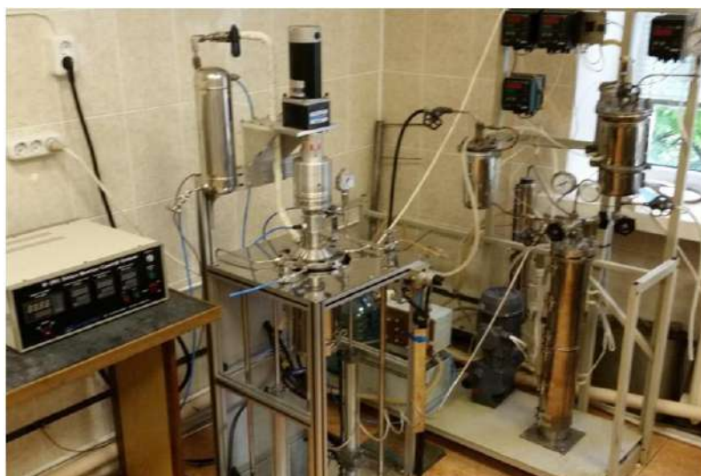
Рис.1 - Лабораторна установка з реактором періодичної дії ChemRe Sys R-201 Series
