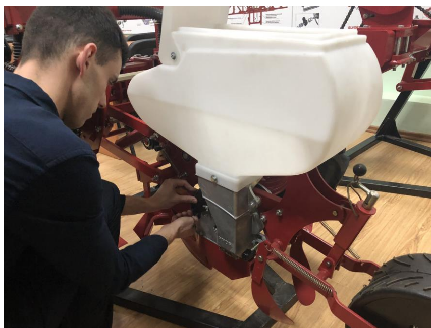
Рис. 11. Проведення досліджень технологічного процесу висіву дрібнонасінневих культур ( налаштування сівалки на сівбу насіння сорго, ріпаку, льону).
