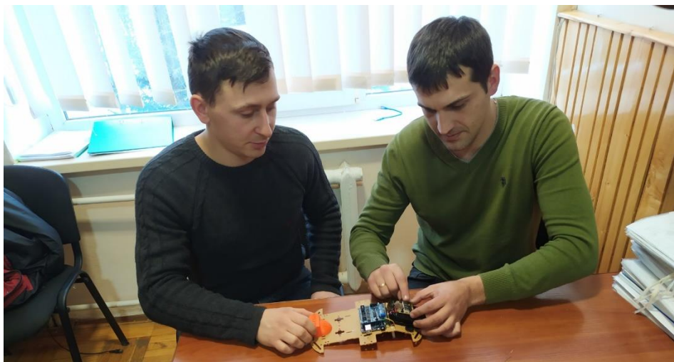
Рис. 11. Розробка апаратної частини експериментального стенда для дослідження параметрів процесу подрібнення сільськогосподарських відходів (налаштування мікроконтролера Arduino UNO)
