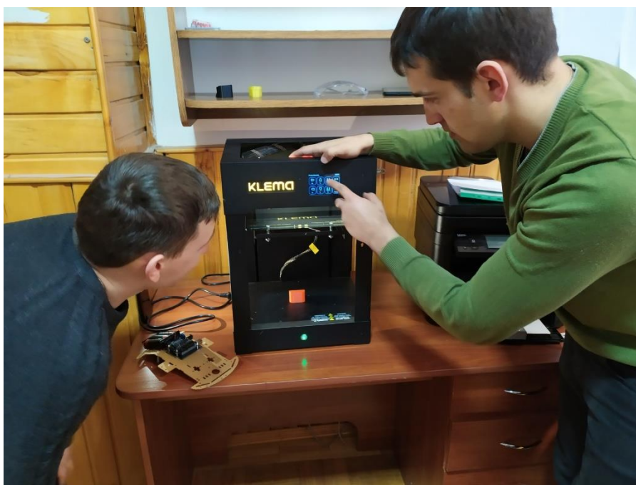
Рис. 12. Виготовлення конструктивних елементів експериментального стенда для дослідження параметрів процесу подрібнення сільськогосподарських відходів (адитивний синтез кронштейнів для датчиків на 3D-принтері KLEMA 180)
