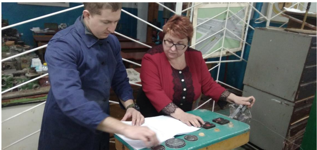
Рис.8. Визначення технічних показників двигуна Д-240 на стенді КИ-5542, 23.09.2018 р.
