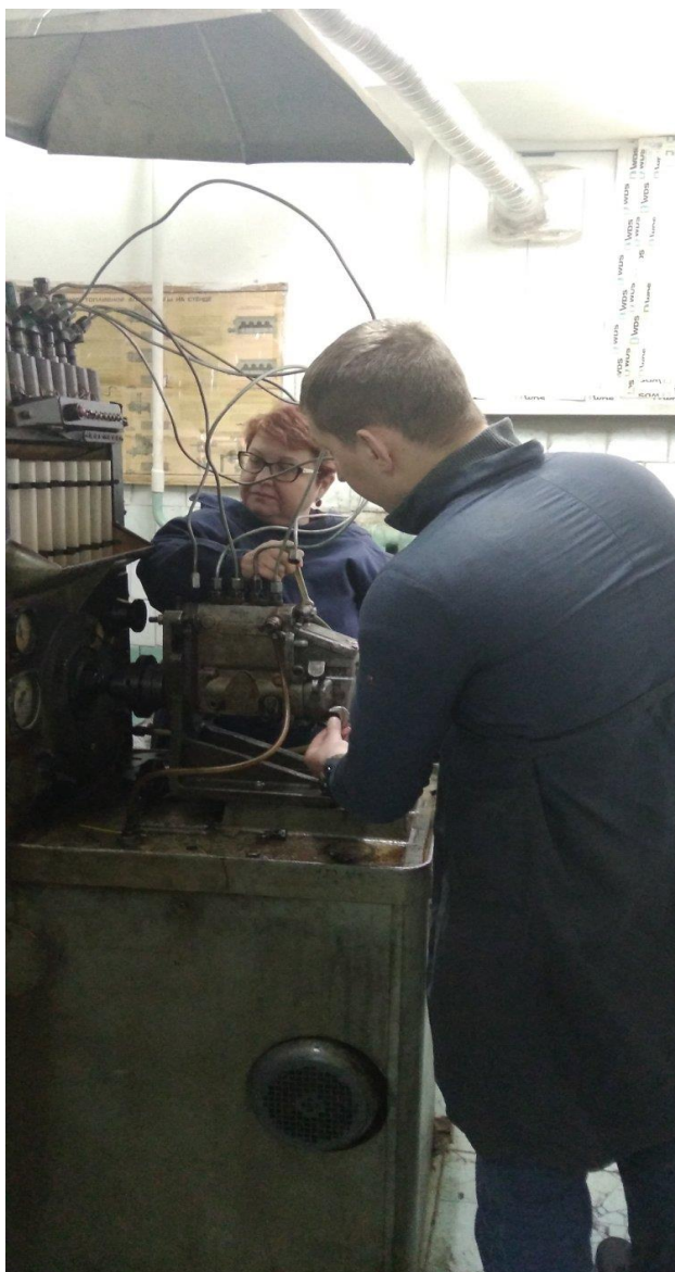
Рис. 9. Регулювання рівномірності подачі паливного насоса високого тиску при використанні сумішевого палива, 14.10.2019 р.
