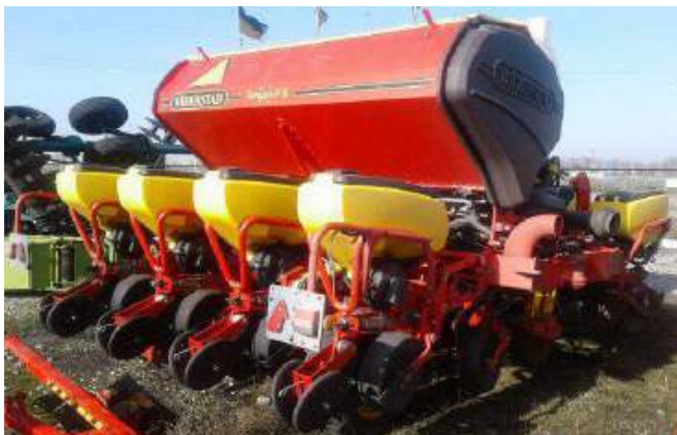
Сівалка причіпна, пневматична, точного висіву з центральним приводом, модель Vaderstad Tempo TPF8
